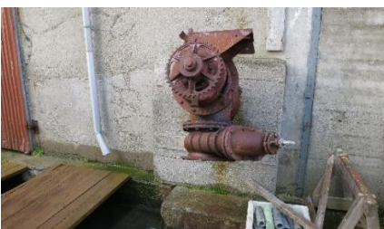
Tv. port mot sør. Th detalj av transportband til høyre for porten, den er koblet til en mateskrue på andre siden av veggen.
