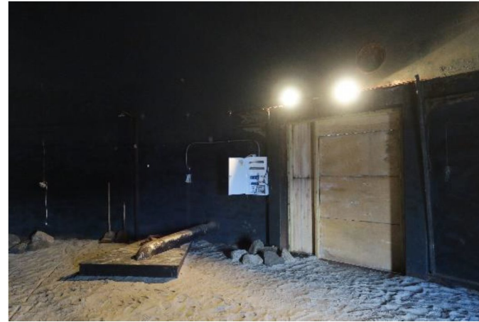
Returrør når skruen tok ut for mye råstoff, sett mot nordøst.
