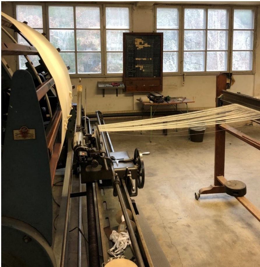
Garn som spoles. Maskinen er en del av 7. rennebommen, oppført i listen over større løst inventar. Foto: Nils Olai Romsvik-Mannes, Sjølingstad Uldvarefabrik 2019
