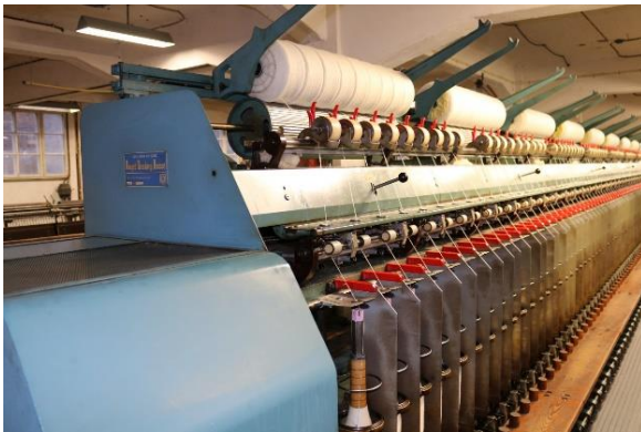
Begge bildene viser detaljer av 6. ringspinnemaskin.
