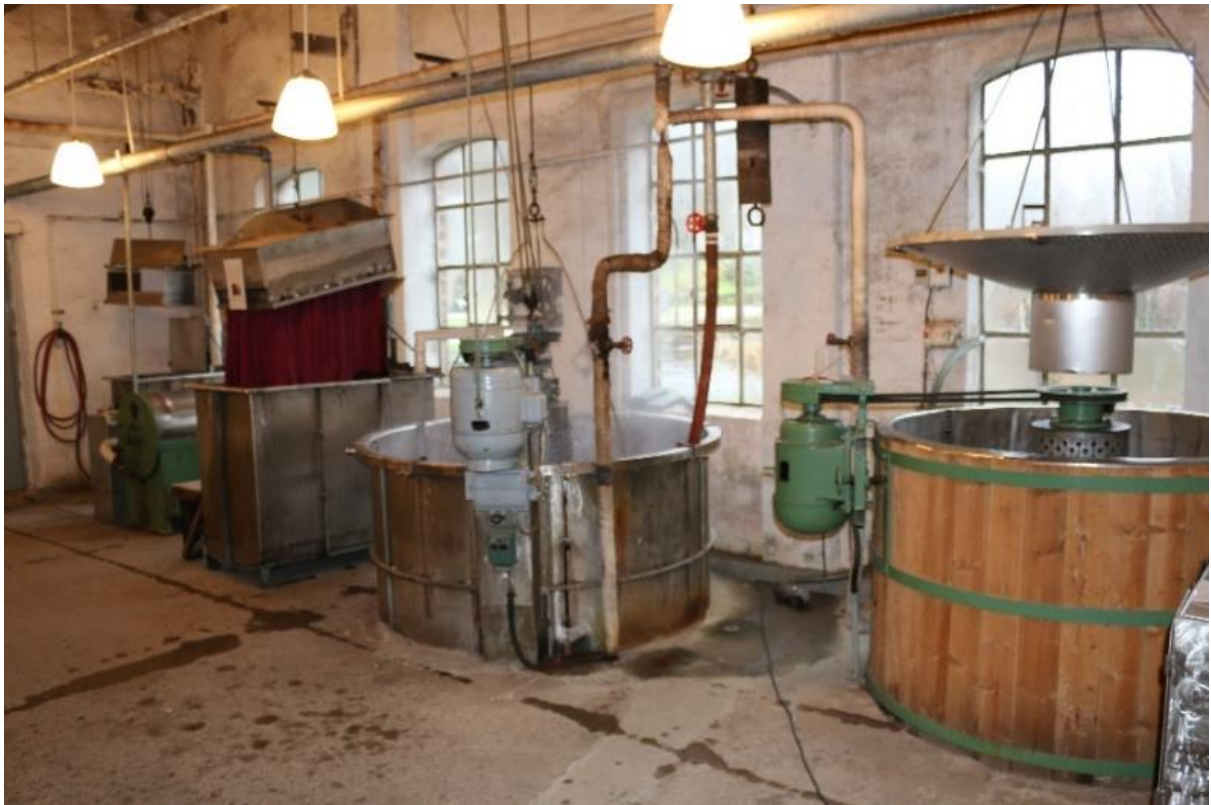
Maskiner fra høyre er 16. løsuulfargekar, 15. løsuulfargekar, 14. garnfargekar, 13. trommelvaskemaskin og 12. garnfargekar. Bildet er sett mot sør/sørøstre yttervegg.
