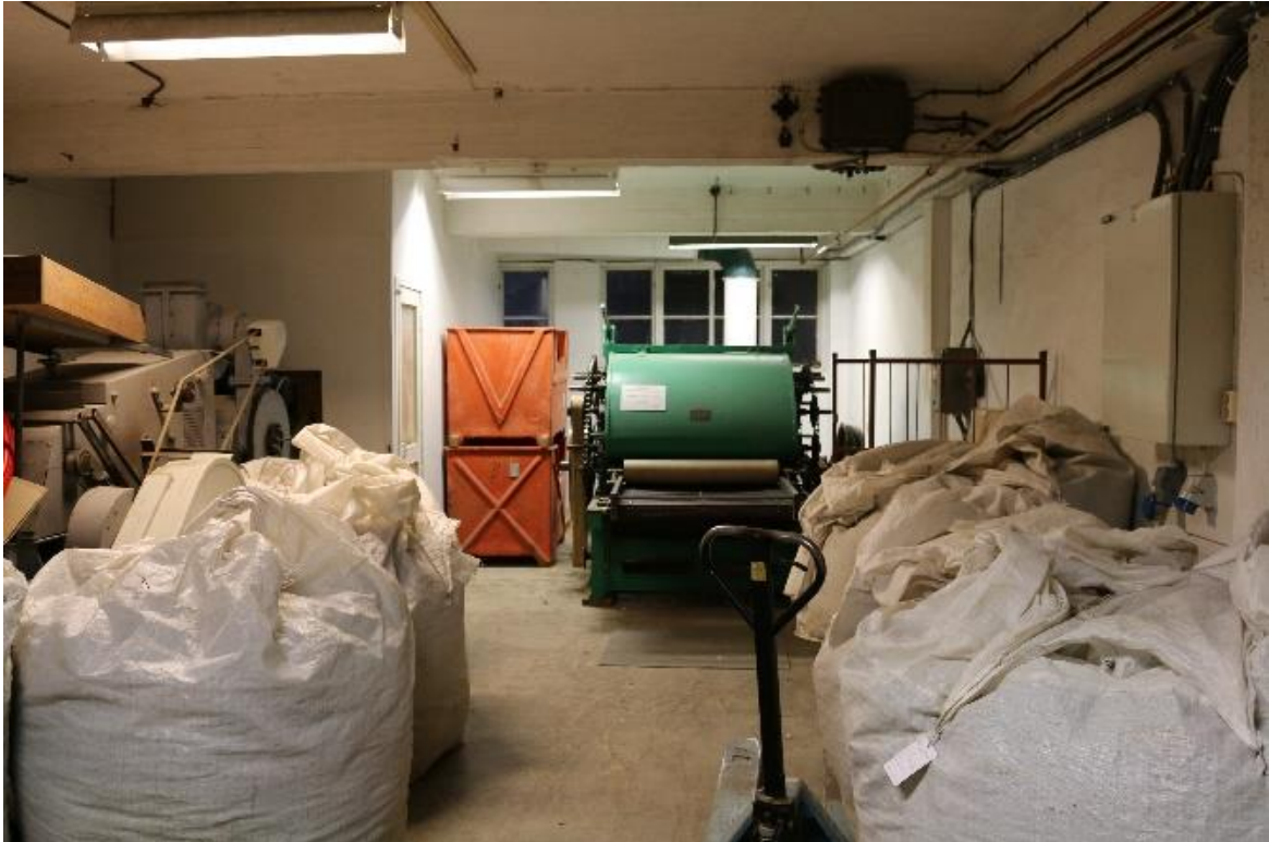
Den grønne maskinen rett frem er 6. plyssmaskin, nordre vegg i bakgrunnen. Maskinen lengst til venstre er 5. rivemaskin. Begge disse benyttes i filtproduksjon.
