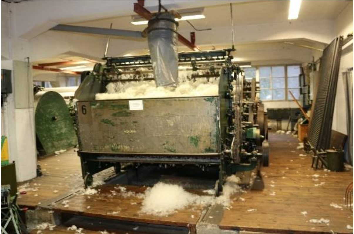
Fra plyssen går ulla til 2. kardeverket. Sett mot nordveggen. Kardeverket står på et podie i tre. Deler av maskinen har hjul og kan ruller frem og tilbake i stålbeslåtte slisser i tregulvet.
