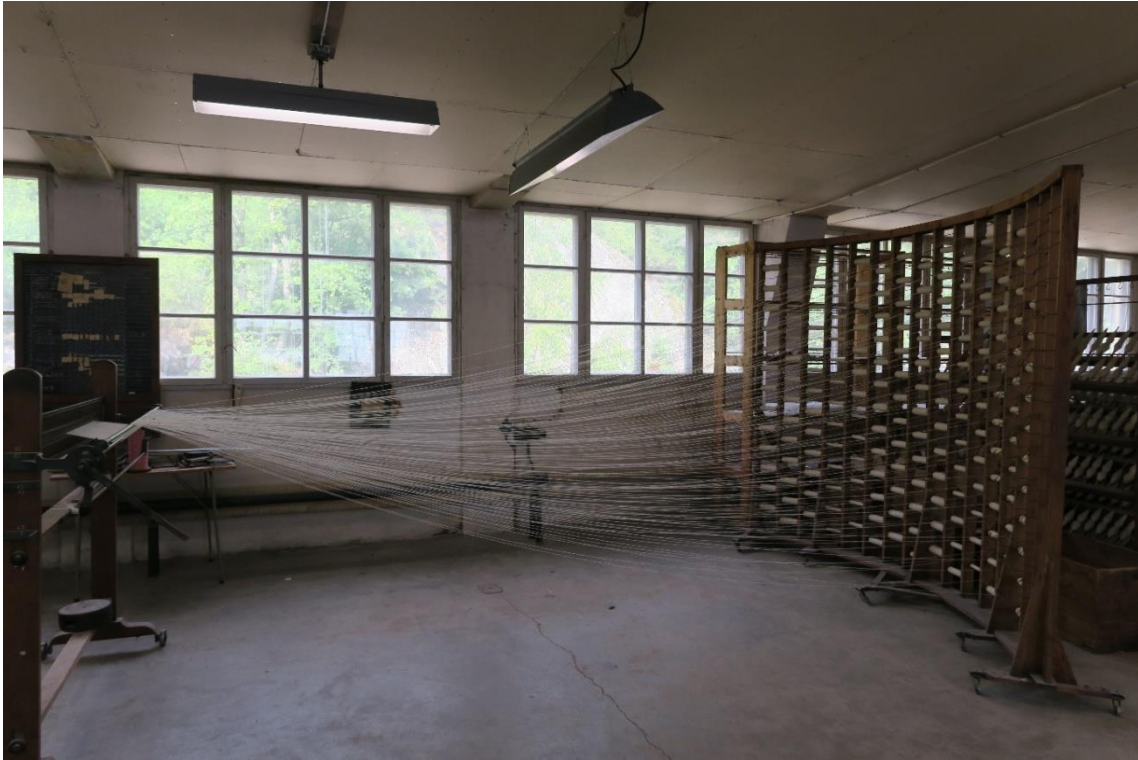
Bildet viser hvordan tråd spoles. Maskinen er en del av 7. rennebommen. Større løst inventar. Foto: Ulf Gustafsson, Riksantikvaren 2015
