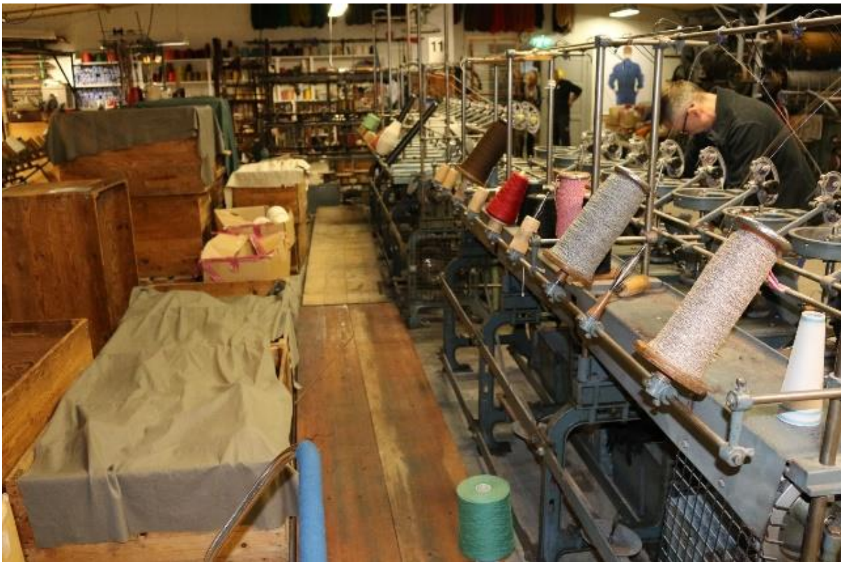
Maskinene 2. og 3. innslagspolingsmaskin sett mot veveriet.
