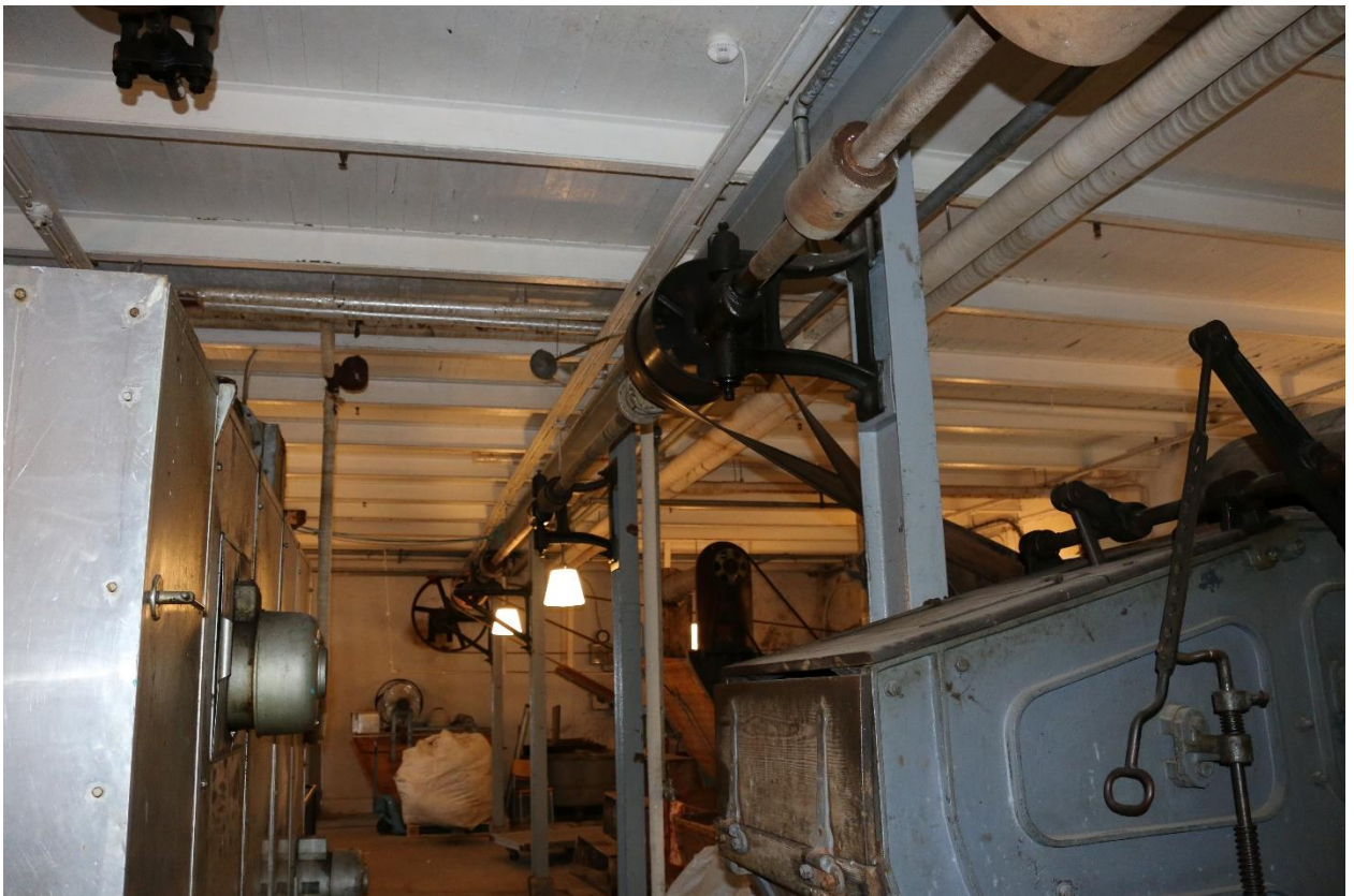
Maskin 11. ulltørke og 3. valke i forgrunnen. Bakre vegg vender mot fargeriet i vest.
