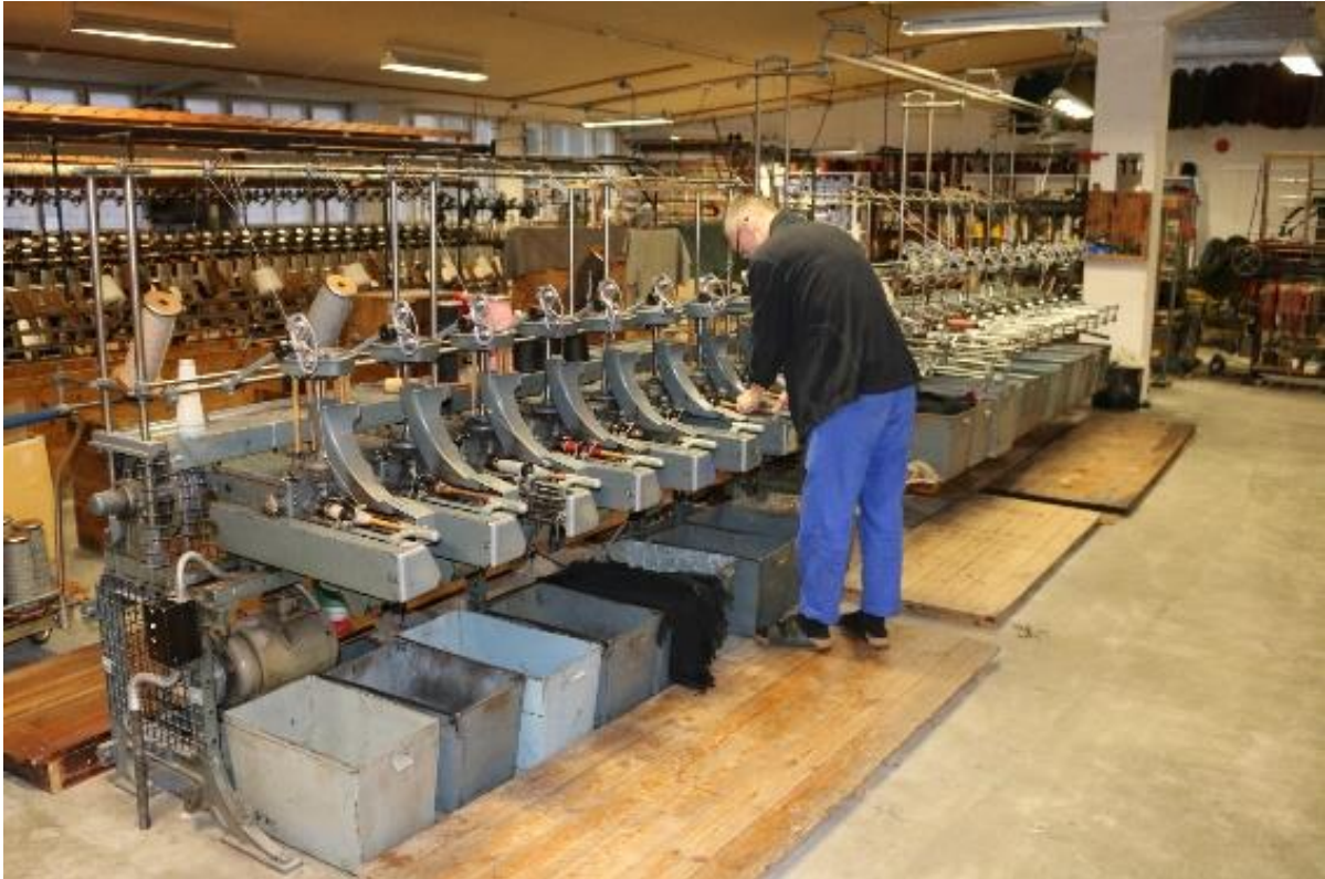
Den første maskinen med mann i arbeid er 2. innslagspolemaskinen, den neste er 3. innslagspolingsmaskin. Sett fra nord/nordøst.
