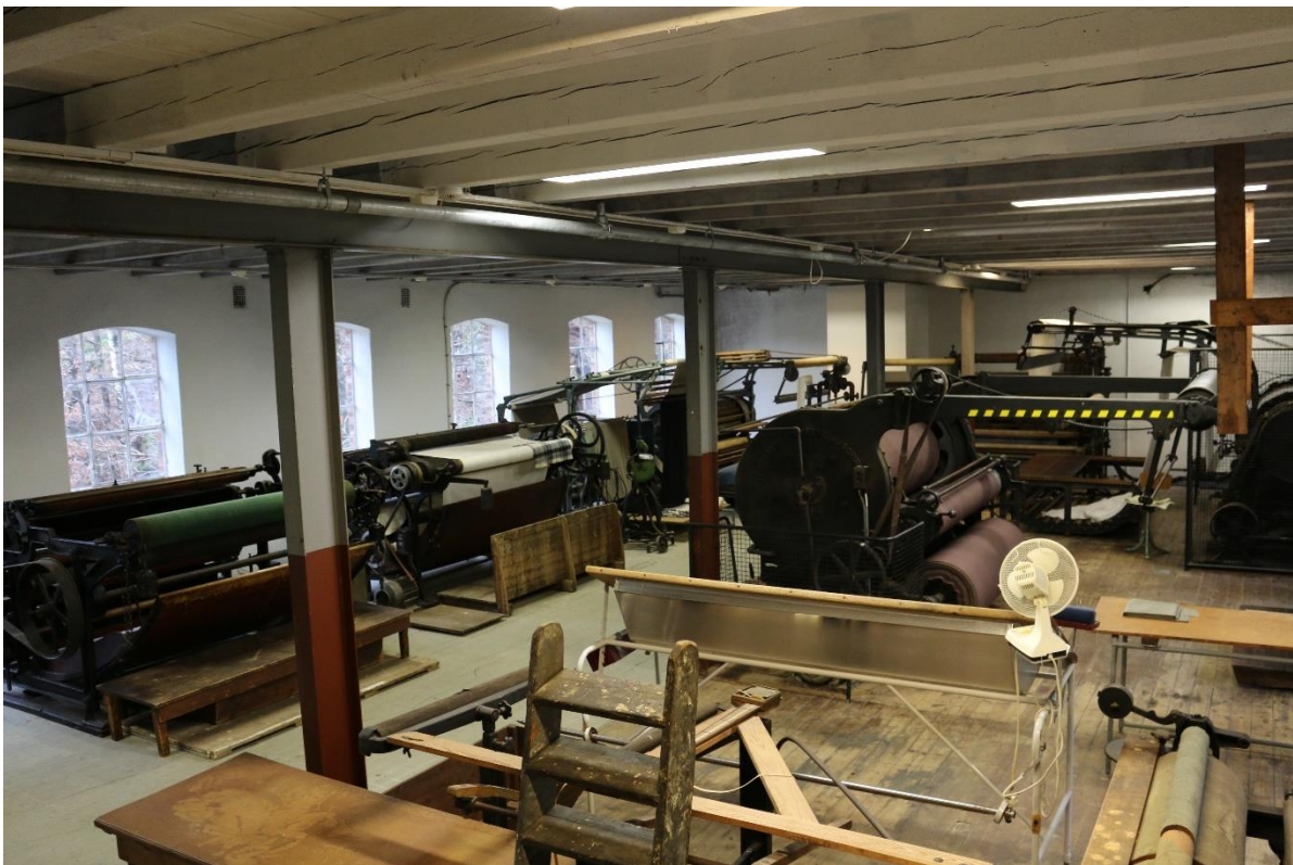
Tørrappretur sett frå nordøst. Maskinen til venstre er 2. skjæremaskin, og maskinen ved siden av er 3. skjæremaskin. Den store maskinen i senter og med lilla tøy er 9. finishdekaturl.
