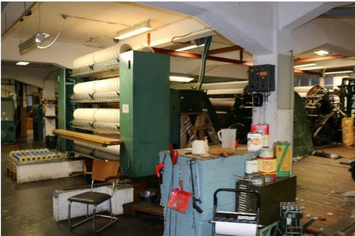
Den grønne maskinen er 3. flordeler som er en del av kardeverket. Flordeleren har hjul og kan trille frem og tilbake på skinner som er lagt oppå betongsokler. Soklene peker ut som to armer fra trepodiet. Større løst inventar: To forskjellige lysarmaturer.
