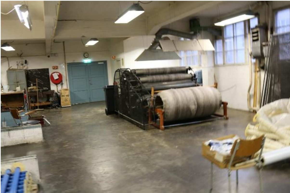
Maskinen i senter er 4. kardeverk. Dette er en innsamlet museumsgjenstand og inngår ikke i interiørfredningen. Dør i bakgrunn leder ut til gangen i byggets østre del. Større løst inventar: To ulike typer lysarmaturer.
