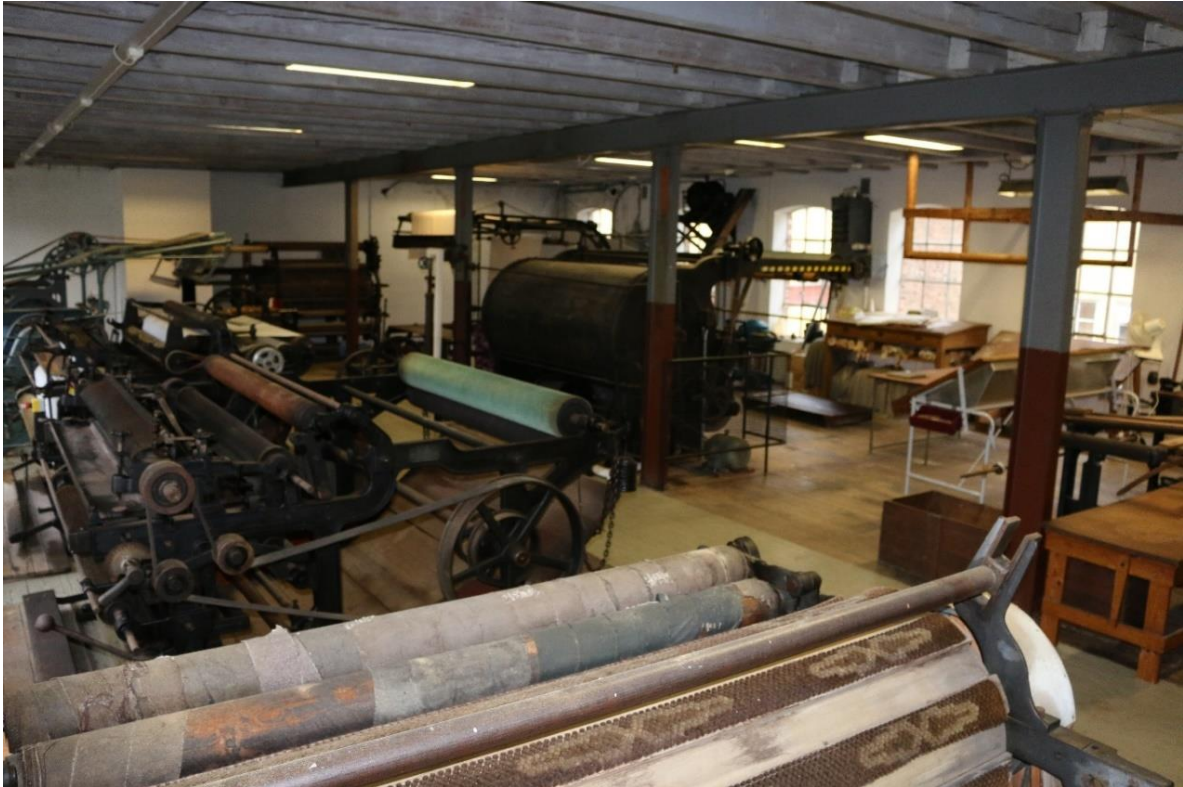
Tørrappretur med 1. dampe-/børstemaskin i forgrunnen, sett fra sørøstre hjørne. Større løst inventar: faste armaturer.
