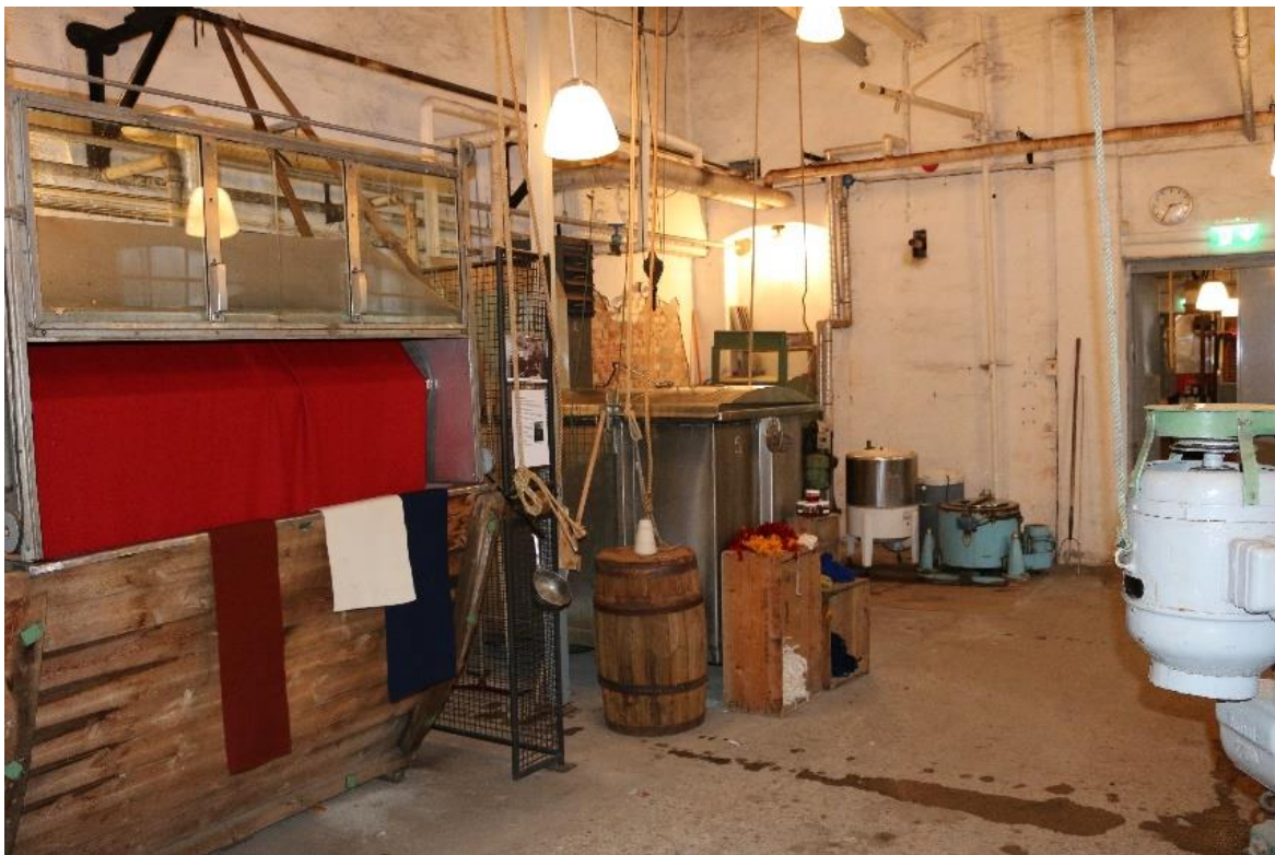
I forgrunnen 17. stykkfargekaret og ved siden av den 18. garnfargekaret. Bak mot veggen er det flere mindre maskiner, fra høyre 21. sentrifuge, 20. vaskemaskin (i rustfritt stål, nedre del hvitlakkert). Fremst på høyre side ses en detalj av 15. løsuulfargekar.
