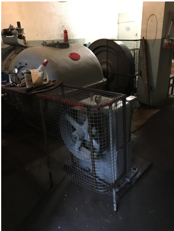
Gammel regulator for vannmengde til turbinen (19). Denne er ikke lenger i drift. Tv. sett fra øst og th. sett fra sørøst.
